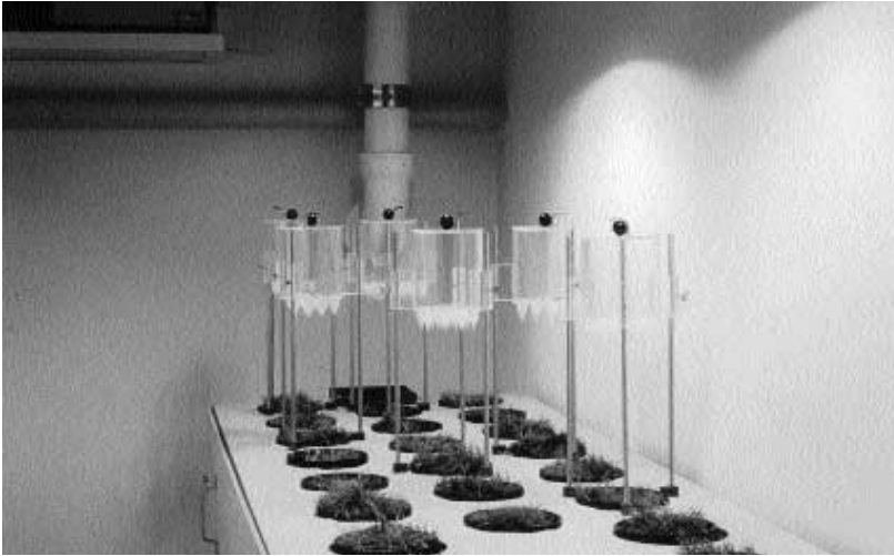
Figuur 2. Met behulp van in het veld gestoken, naar een klimaatkamer in het laboratorium overgebrachte bodemkolommen kan men de invloed van gewasbeschermingsmiddelen op het bodemleven bestuderen. Dergelijk onderzoek vindt bijvoorbeeld plaats aan de Vrije Universiteit te Amsterdam.
