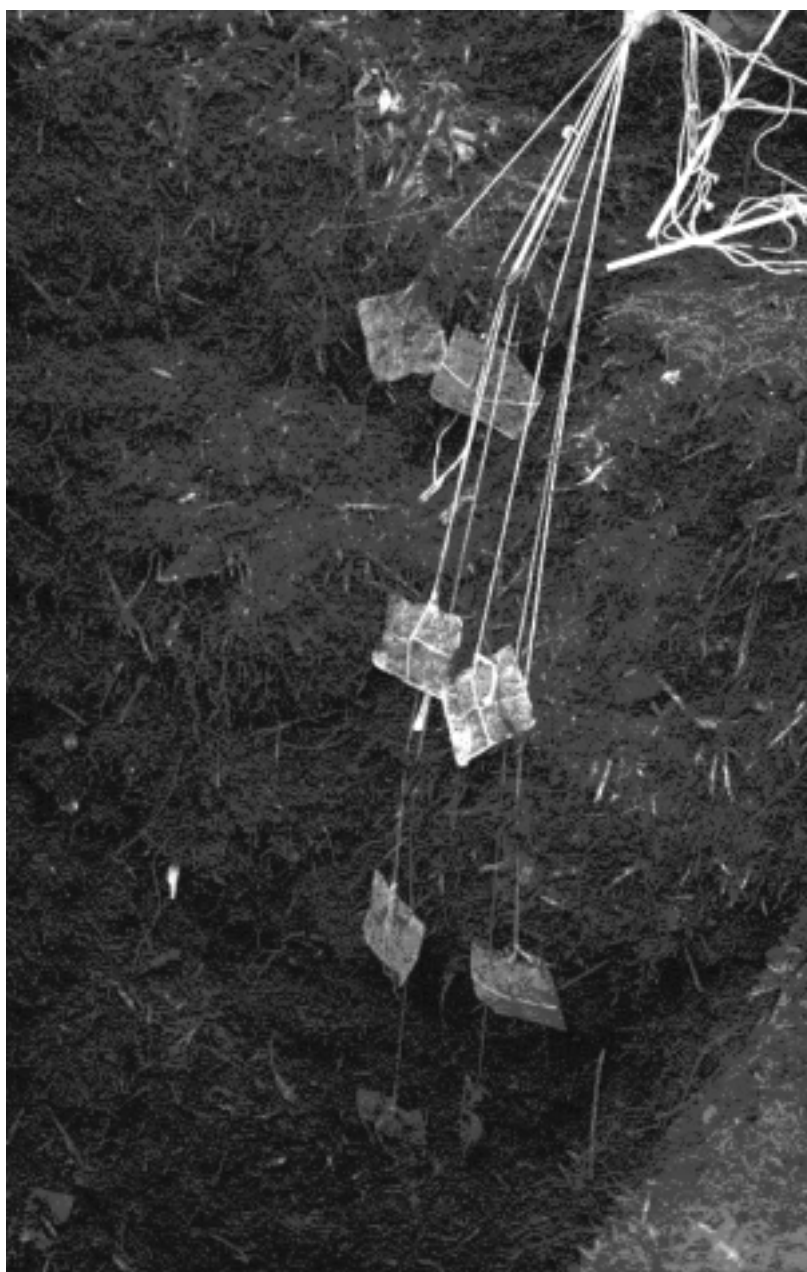
Figuur 1: Metaalnetjes gevuld met geïnfecteerde plantendelen en onkruidzaden worden ingebracht op 4 dieptes in compostierend GFT- of groenafval.
