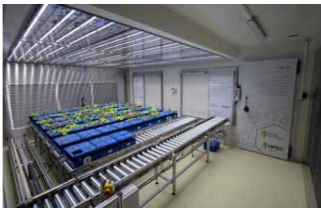
Planten in de groeikamer van Helios, met de transportband voor een volautomatische reis langs sensoren, camera's en een 3D-laserscanner (foto: UU).
