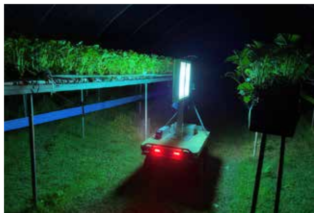
De UV-robot aan het werk om meeldauw tegen te gaan (foto: Antobot).
