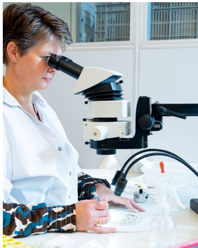
Microscopisch onderzoek naar AM: het tellen met behulp van een microscoop van cysten die uit grond zijn opgespoeld (foto: HLB).
