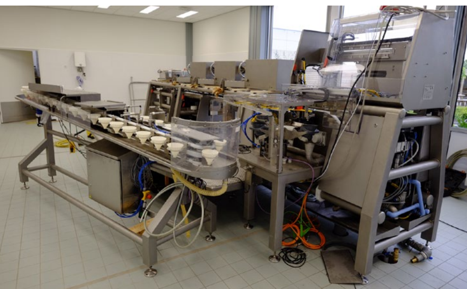
Machine NAK voor geautomatiseerd spoelen van grondmonsters.
